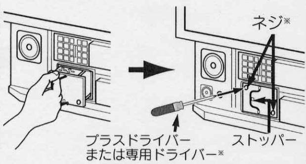
※ネジ頭の溝が特殊な形状のセットは、専用ドライバーがテレビ本体の内装品に同梱されています。
